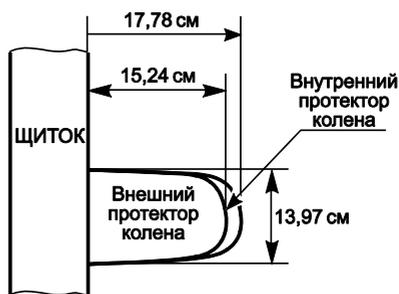
Рисунок 25. Внешний и внутренний протектор колена
